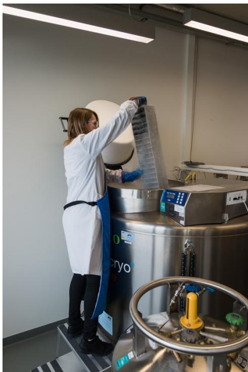
Stockage de nouveaux échantillons dans une cuve d'azote liquide. Crédits : IBBL
